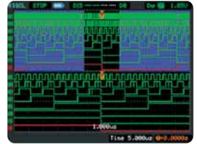
Déclenchement sur durée Combinaison de déclenchement Pattern et largeur d'impulsion
