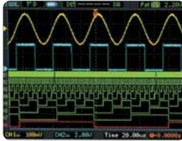
Déclenchement Pattern La condition de déclenchement est une combinaison de niveaux et de fronts
